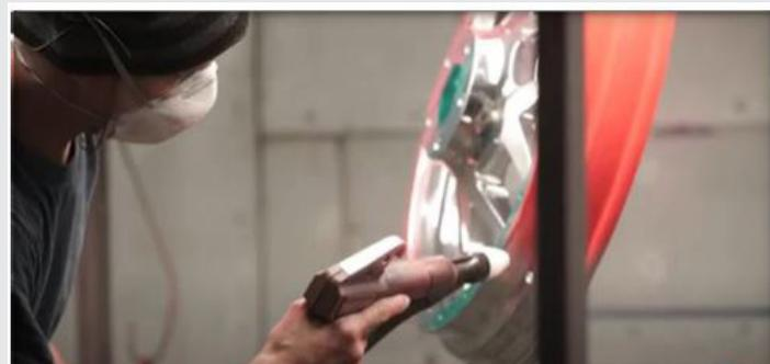
Figura 2. Aplicación de pintura metálica a un rin de aluminio forjado.
